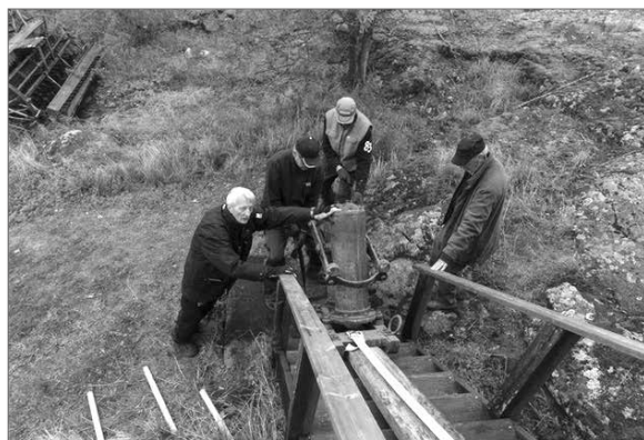
Här glider en tung pump nedför Magasinet's trappa. Observera bandet som är broms.
